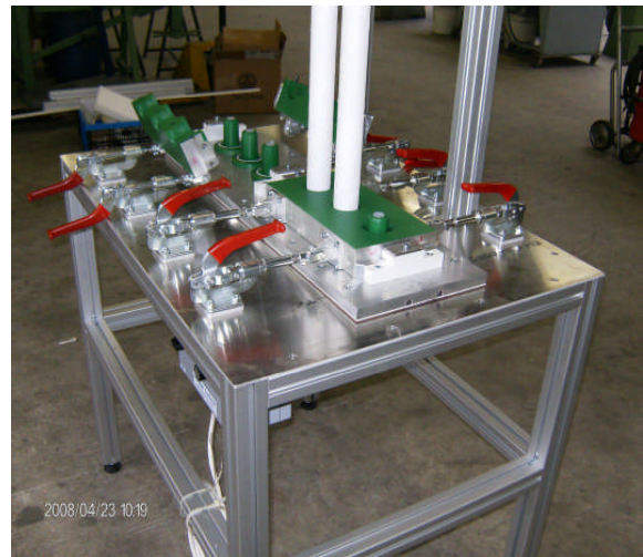
Tisch aus Aluprofil mit Heizung und Giessformen
